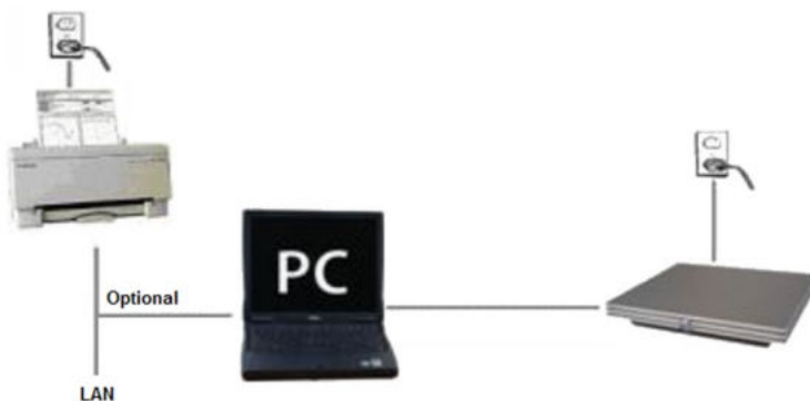
图 2: Eclipse 由市电电源供电，并通过 USB 数据线连接到计算机。计算机可以连接到其他设备，且仍可确保患者安全。
